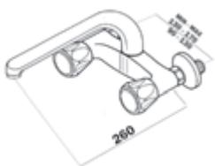
**Distancia entre entradas de 130-170 mm y caño fundido de 26 cm**
